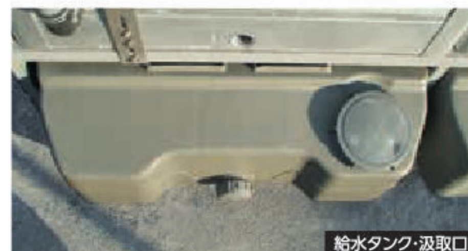
給水タンク・取出口
